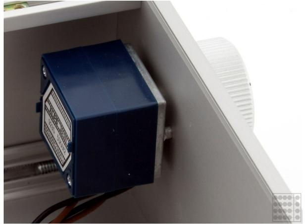
Gelegentlich wird nach dem Sinn eines Potentiometers in einer Endstufe gefragt. Eine veränderbare Eingangsempfindlichkeit ist gewiss unverzichtbar und bei ABACUS ist diese Funktion ohne Nachteile zu einer vollwertigen Lautstärkeregelung ausgebaut. So wird die Endstufe dank Poti gleichwertig zu einem Linear-Vollverstärker und lässt sich ganz ohne Vorstufe betreiben, sofern (jeweils) nur eine Programmquelle angeschlossen wird.
