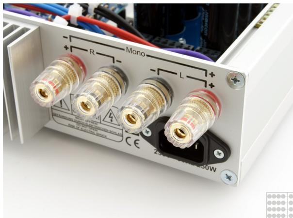
Vollisolierte und vergoldete Lautsprecherklemmen bieten sicheren Kontakt, sowohl für Bananenstecker, als auch für dicke Kabelenden. Die Einschaltgeräuschunterdrückung arbeitet ohne sonst übliche Relais im Lautsprecherausgang. So ist der Musik von den Endtransistoren bis zu den Lautsprechern nichts im Weg.
