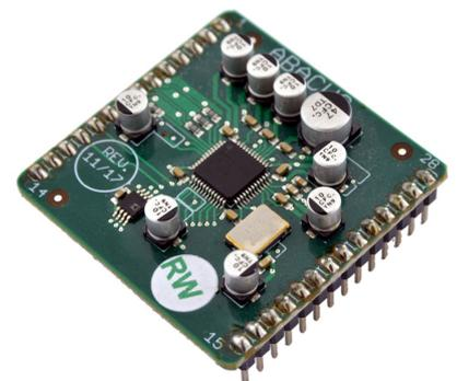
Für versierte Anwender gibt es auch die Möglichkeit, den internen DSP von außen zu programmieren. Damit lassen sich die Abstimmung der Frequenzweiche anpassen, Verstärkermodule für OEM- und DIY-Projekte modifizieren oder auch einfache Raumkorrekturen realisieren. Für weitere Informationen dazu wenden Sie sich bitte im Vorfeld an ABACUS!
