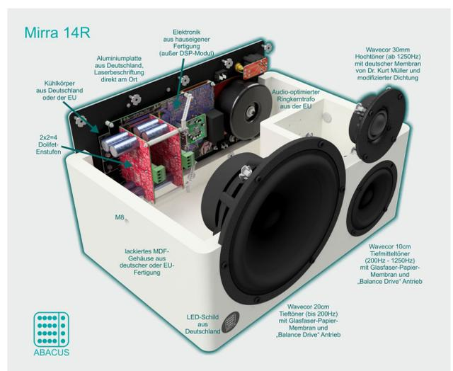
Auf Basis der Cortex-Elektronik und einiger bekannter und neuer Chassis wurden im Labor dazu die optimale Bestückung und Konfiguration erarbeitet. Ein Frequenzgang mit einer Abweichung nicht größer als  $\pm 1$ dB von unter 30Hz bis knapp 20kHz konnte dabei schon früh als erreichtes Ziel verbucht werden. Die Cortex-Elektronik wurde schließlich für den neuen Einsatzzweck kräftig aufgebohrt und angepasst.
