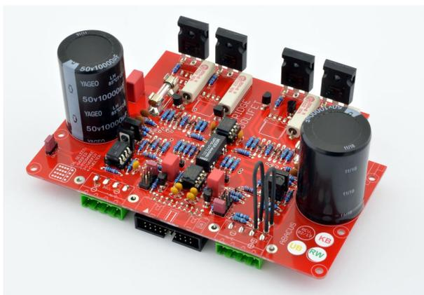
Für den Tiefmitteltöner bekommt die Oscara ein Brückenendstufenmodul. Dieses Modul besteht im Grunde aus zwei kompletten Dolifet-Verstärkern, die gegeneinander arbeiten und so mit der doppelten möglichen Spannung auf die Schwingspule gehen. Außerdem muss sich der Lautsprecher nicht am Minuspol "festhalten", sondern hängt zwischen zwei aktiven Verstärkerausgängen. Gerade bei einem solchen Lautsprecher, der eigentlich aus dem professionellen Bereich stammt, bringt das zusätzliche Dynamikreserven.
