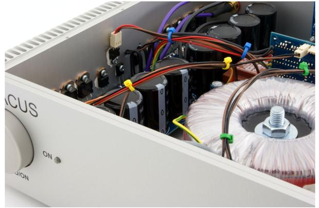
Wie bei allen physikalischen Vorgängen gilt: Was man nicht vorher reinsteckt, kann auch nicht rauskommen. Ein abgestimmtes Zusammenwirken von Netztransformator und Elektrolytkondensatoren (Elkos) bestimmt die Leistung. Die liefern nämlich dem Verstärker Spannung und Strom und der versorgt damit die Lautsprecher.
