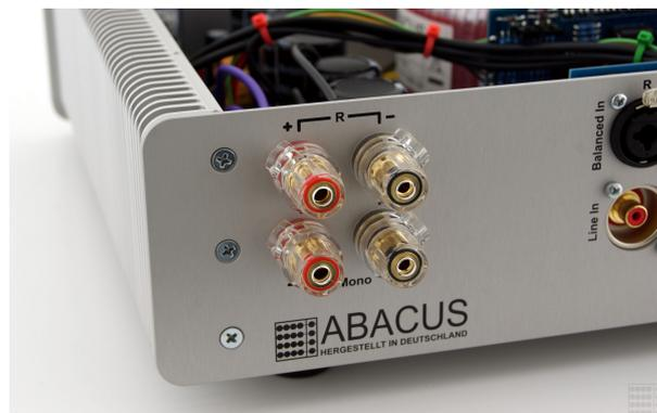
Auf der Rückseite des Ampollo befindet sich auf jeder Seite ein doppeltes Paar vollisolierter Polklemmen. Diese sind jeweils durch eigene Leitungen mit der Leiterplatte verbunden, direkt an den Endtransistoren. Erst so wird ein echtes Bi-Wiring möglich.
