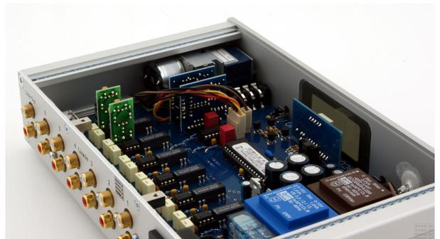
Am Ausgang des Prepino haben dank der Linetreiber-Technik Kabel und Eingangseigenschaften der Folgekomponenten keinen Einfluss auf das Signal. Das Ausgangssignal kann praktisch nicht verändert werden. Der Kauf teurer Kabel ist darum nicht nötig – aber auch nicht schädlich.
