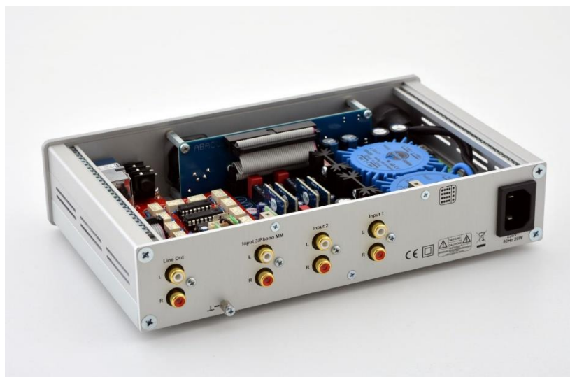
Cuffino – Rückseite, Anschlüsse, Innenleben (mit Widerstandsleiterpotentiometer)
