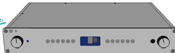
Preamp 14 mit AroioEX-Modul: nimmt die fertig als „Stream“ verpackten digitalen Audiodaten, bereitet sie ggf. mit Raumkorrekturdaten auf und wandelt sie in ein analoges Signal, welches der Vorverstärker ausgibt.
