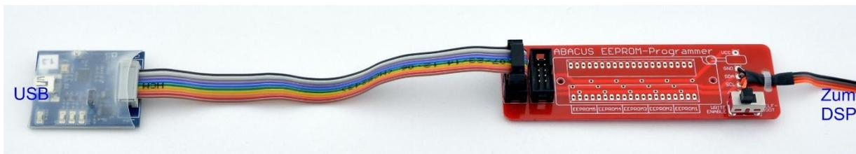
Um zwei oder mehr Geräte gleichzeitig mit demselben Programm zu beschreiben, können zwei dieser Adapterplatinen mittels Flachkabel verbunden werden. Das ist z.B. bei einem Stereopaar Lautsprecher zweckmäßig.
