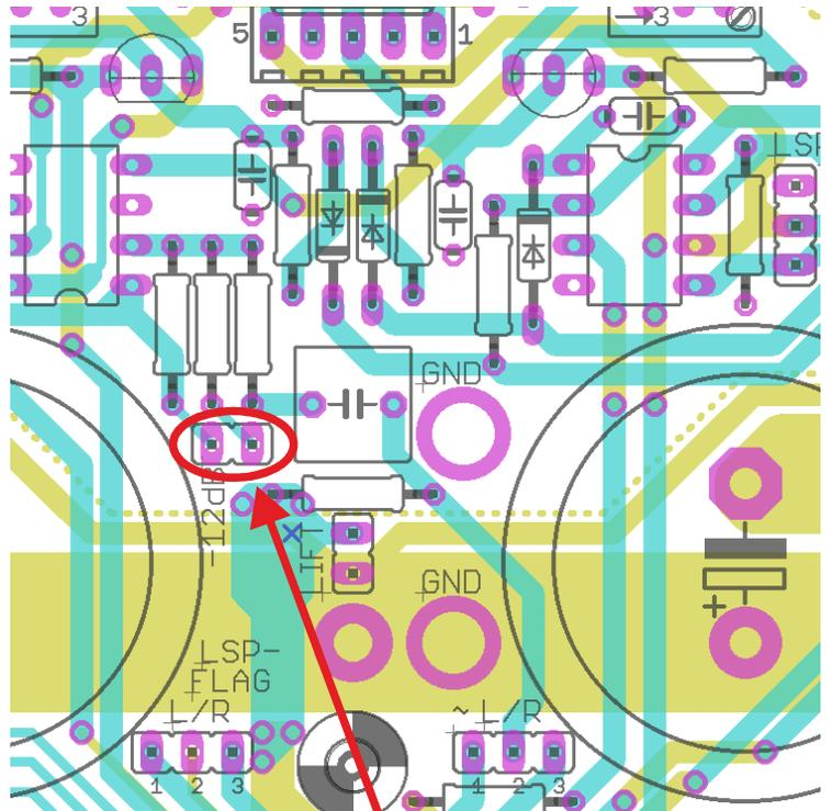
Durch überbrücken dieses Jumpers (Steckbrücke) werden alle Werte um 12dB reduziert. Das ist sinnvoll für wirkungsgradstarke Lautsprecher (z.B. Hörner), denn dadurch reduziert sich auch der Grundgeräuschpegel.
